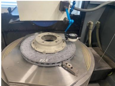
Une fois sorti du four, le rotor a une nouvelle surface de friction qui est brute, il sera rectifié avec une rectifieuse diamant pour redevenir plan et pour le ramener à ses dimensions nominales
