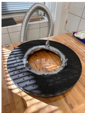
Après avoir effectué toutes les vérifications, si le disque est apte pour être rénové, nous démontons le bol et allons préparer le rotor à recevoir sa nouvelle surface de friction Rebrake, pour cela, il sera nettoyé avec un procédé de décapage thermique, permettant d'éliminer toutes les pollutions accumulées au fil des kilomètres
