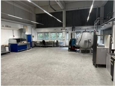
Une fois la nouvelle céramique déposée, pour pouvoir la fixer sur le support original, le rotor sera cuit à 1300 degrés Celsius pendant 12H avec un four autoclave
